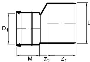
PipeLife nr. D, mm D1, mm Z1, mm Z2, mm M, mm
