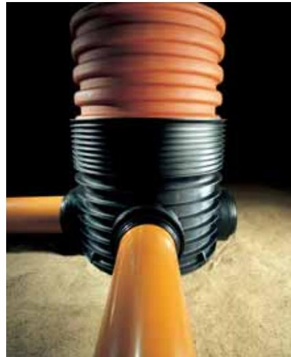
Гофрированная труба производится из полипропилена (ПП) размером Ø600/670 мм. Труба может поставляться длиной 1,0; 2,0; 3,0 и 6,0 м. В случае возникновения необходимости по её удлинению, необходимо применять гофрированную трубу с раструбом (длиной 3,65 м), а также дополнительно уплотнительное кольцо для гофрированной трубы DN 600.
