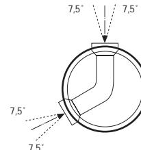
**Пропускная лотковая часть 60° (120°)**Возможность плавной регулировки угла в пределах  $60 \pm 15^\circ$
