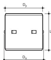
■ в комплекте с двумя уплотнительными кольцами для гофрированной трубы
