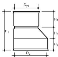
■ для перехода с гофрированной трубы Ø425 мм на телескопический адаптер Ø315 мм
