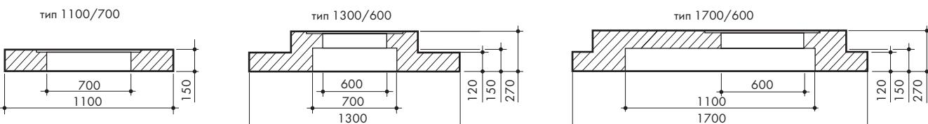
**Класс А 15** — крышка без корпуса для сборки непосредственно на конической горловине без разгрузочного кольца (чаще всего применяется в зелёных насаждениях).
