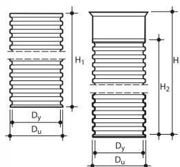
■ шахтная труба канализационного колодца без уплотнительного кольца
