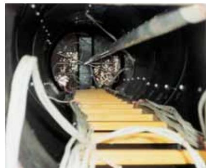
В 2000 году в г. Бук также была смонтирована испытательная сеть с целью проверки прочностных качеств инспекционных колодцев «Тегра 600». Испытывается влияние статических и динамических нагрузок на статику основания колодца, а также возможность компенсации пере-
