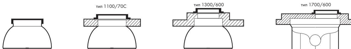
**Типы бетонных разгрузочных колец**
