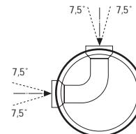
**Пропускная лотковая часть 90°**Возможность плавной регулировки угла в пределах  $90 \pm 15^\circ$
