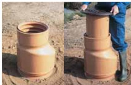
9. В случае возникновения необходимости применения люков колодца диам. 315 на шахтной трубе диам. 425, перед их сборкой необходимо в гофрированную трубу установить специальную переходную муфту 425–315 мм..
